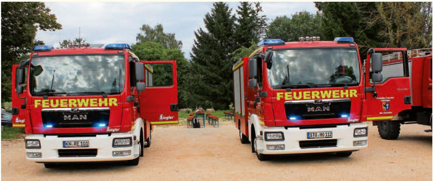
Am 31. Juli konnten die neuen wasserführenden Tragkraftspritzenfahrzeuge (TSF-W) in Sachsen bei der Firma Ziegler abgeholt werden. Aufgebaut auf einem MAN-Fahrgestell sind sie bei einem Gesamtgewicht von rund 7,5 t mit Equipment für einen erfolgreichen Ersteinsatz beladen und bieten 6 Feuerwehrangehörigen Platz.
