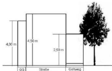
Um Beeinträchtigungen zu vermeiden, muss bei öffentlichen Verkehrsflächen der Luftraum über der gesamten **Fahrbahn** eine Höhe von **4,5 m**, über **Geh- und Radwegen** ein Luftraum in Höhe von **2,5 m** und über einem 0,5 m breiten **Geländestreifen (GS)** neben der Fahrbahn (wenn kein Gehweg vorhanden ist) eine Höhe von **4 m** von überhängenden Ästen und Zweigen freigehalten werden. Der Bewuchs ist entlang der Geh- und Radwege bis zur Geh- und Radweghinterkante zurückzuschneiden.
