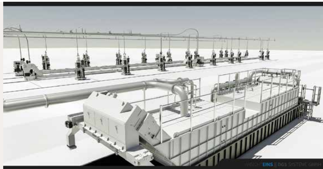
Zentrale Kühlmittelversorgungsanlage zur Stahlkolbenproduktion für 2 Fertigungslinien mit einer Filterleistung von 5.500 l/min.
